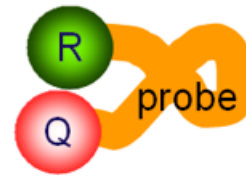
图 11. TaqMan® 探针图示。R 为报告基团染料，Q 为淬灭剂分子，橙色的线条表示核苷酸。
